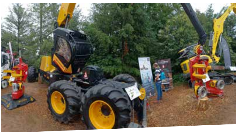
Abatteuse adaptée à un relief escarpé
