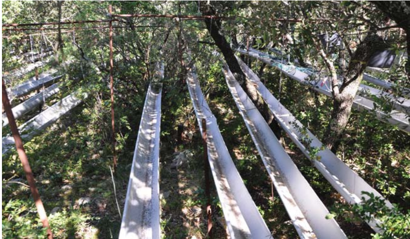
Le dispositif d'exclusion de pluie sur le site de Puéchabon (© CEFE-CNRS)
