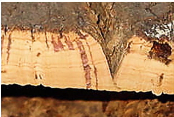
Figure 22 – Détail de liège crevassée
