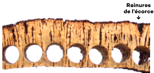
Figure 25 – Bande de gros calibre où les rainures de l'écorce ne nuisent pas au tubage de bouchons naturels
