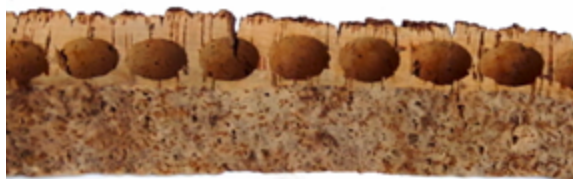
Figure 26 – Bande de marque où il est possible de tuber des bouchons naturels avec qualité malgré le ventre irrégulier et faible
