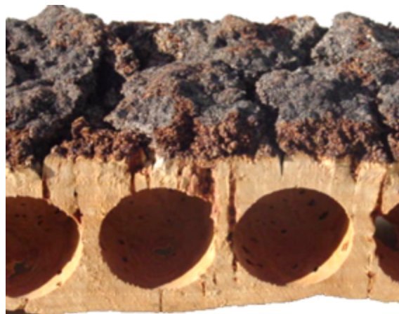
Figure 27 – Avec fente profonde, sans influence dans la qualité des bouchons
