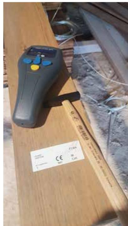
Machine de classement mécanique
